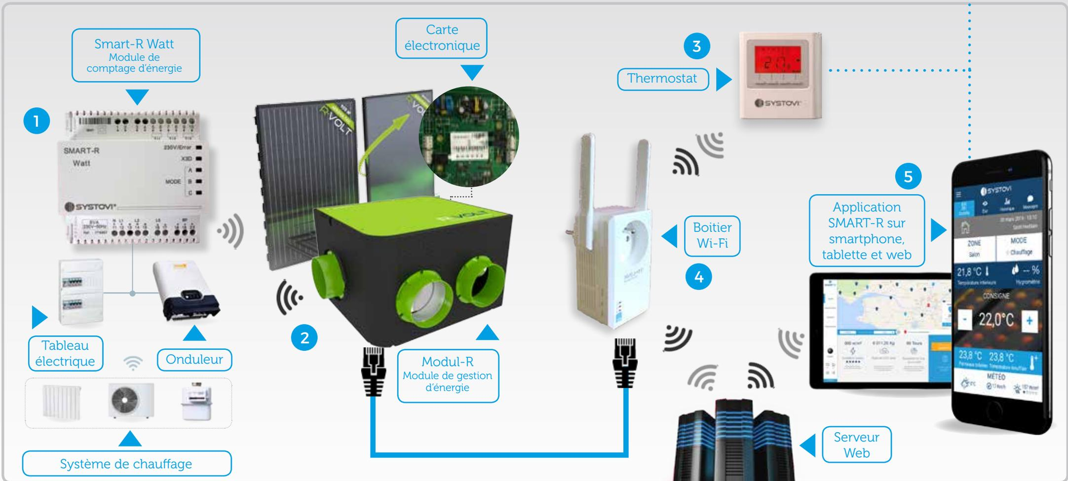
1/ Le SMART-R Watt est un module de comptage d'énergie qui récupère les données relatives à votre consommation et production électrique pour les envoyer au module de gestion d'énergie. Tout cela est assuré par transmission radio.
